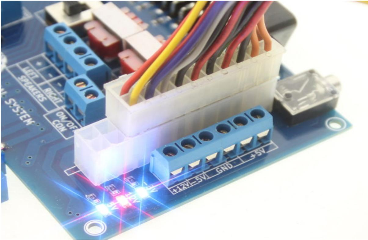
On voit ici parfaitement les 4 pins libres du connecteur 24 pins ATX, et la LED -5V s'allume, ce qui signifie que cette alimentation fournit également du -5V (vive les vieilles alims:)
