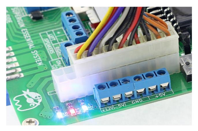
On voit ici parfaitement les 4 pins libres du connecteur 24 pins ATX,et la LED -5V s'allume,ce qui signifie que cette alimentation fournie également du -5V (vive les vieilles alims:)
